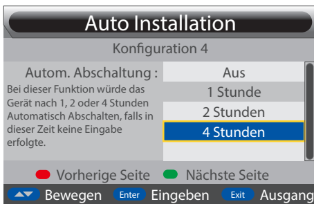
Bild 22 Erstinstallation - automatische Abschaltung einstellen
